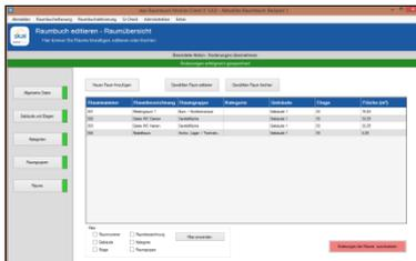
Raumbücher werden mittels einer App vor Ort erfasst und auf den Server nach Fertigstellung übertragen. Vorhandene Raumbücher können aus Excel importiert werden. Die Qualitätsprüfung wird menügesteuert aufgerufen und nach wenigen Minuten stehen alle vorausgefüllten Dokumente zur Bearbeitung bereit.
